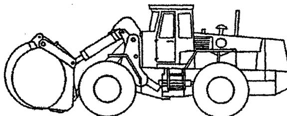
Esempio di caricatore a ruote con pinza
